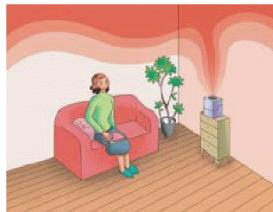
При работе бытового увлажнителя обработанный воздух скапливается в верхней части помещения.
