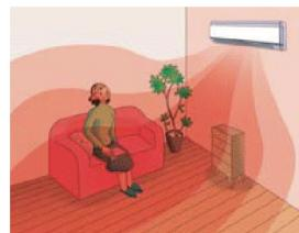
При работе FTXR воздух при помощи конвективного перемешивания равномерно распределяется по всему объёму помещения.
